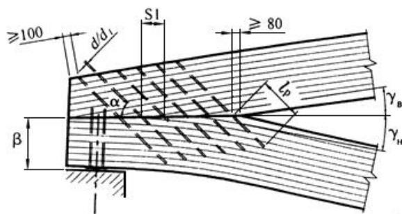
**Рисунок 24 - Схема опорного узла линзообразной фермы**
