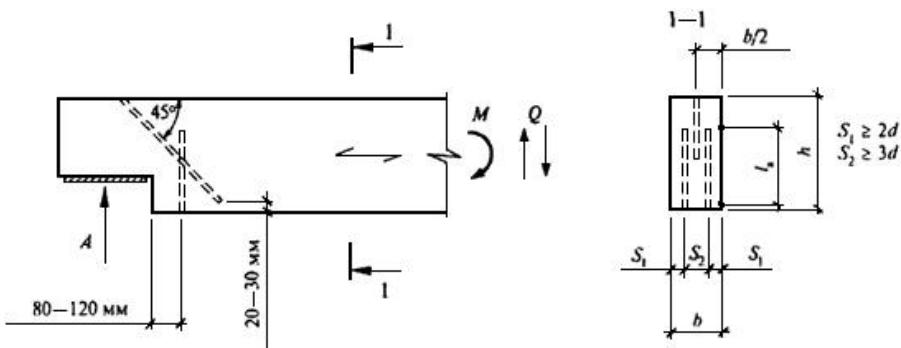
Рисунок 20 - Усиление подрезки на конце балки
