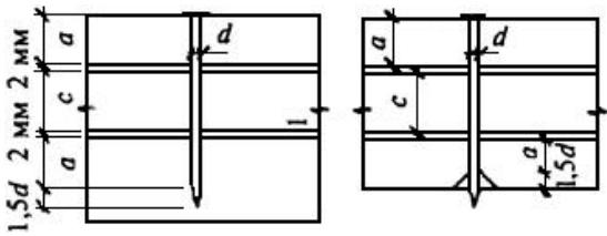
Рисунок 12 - Определение расчетной длины защемления конца гвоздя
