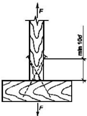
Рисунок 14 - Наклонная забивка гвоздей
