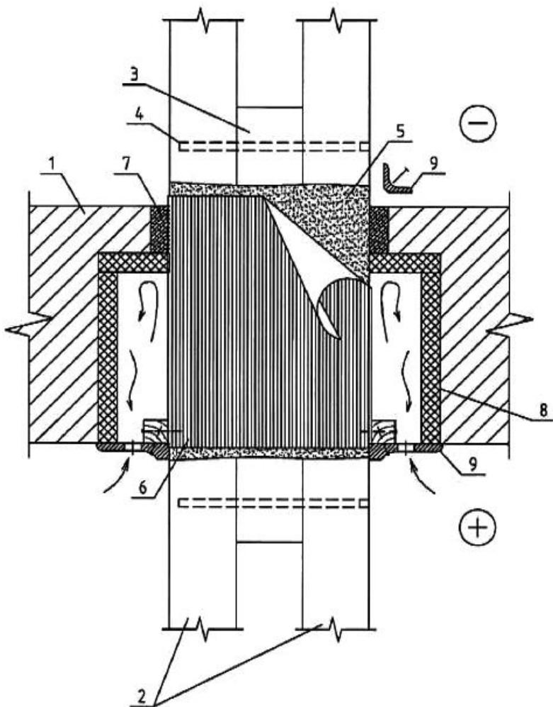
1 - наружная стена; 2 - спаренная несущая КДК; 3 - КДК вставка; 4 - вклеенный металлический стержень; 5 - поверхность, обработанная антисептиком; 6 - влагоизоляционный бандаж; 7 - монтажная пена; 8 - плитный утеплитель; 9 - нащельник (плитнус)
