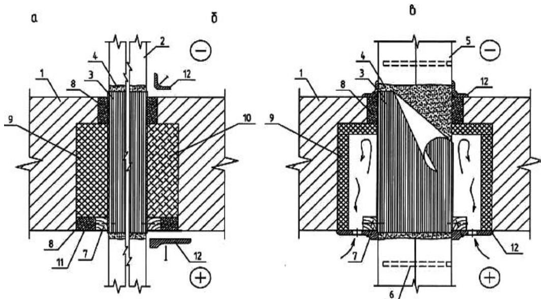
1 - наружная стена; 2 - несущая КДК; 3 - влагоизоляционный бандаж; 4 - поверхность, обработанная антисептиком; 5 - спаренная несущая КДК; 6 - вклеенный металлический стержень; 7 - деревянный брусок сечением 40х40 мм; 8 - монтажная пена; 9 - плитный утеплитель; 10 - заливочный ППУ; 11 - самоклеящаяся герметизирующая лента; 12 - нащельник (плинтус)
