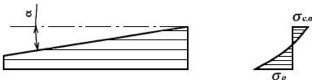
Рисунок 21 - Односкатная балка
